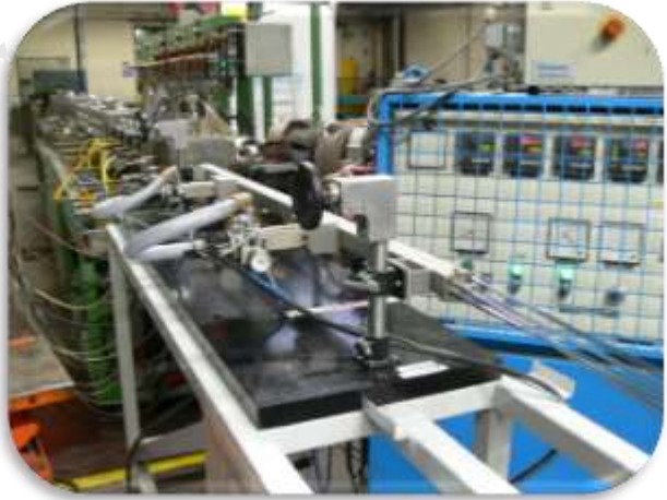
Guiado de los cables de acero
