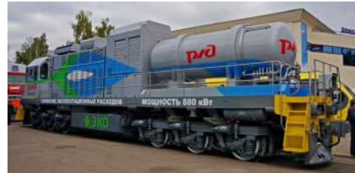
Locomotora rusa de maniobras. 1.200 CV
